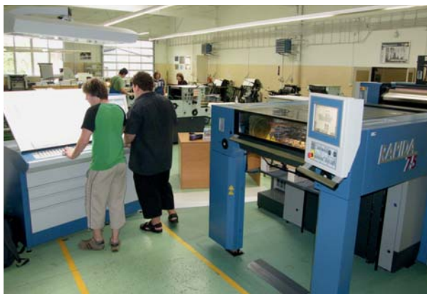
Dvoubarvový stroj KBA Rapida 75-2
